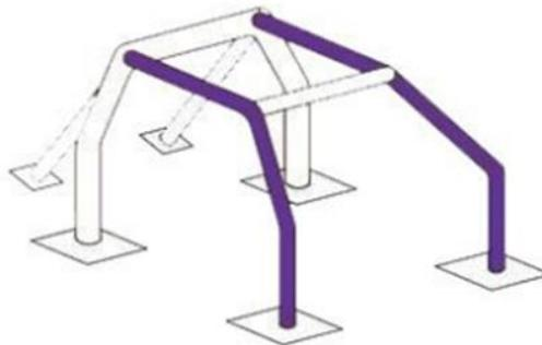
Configuration des arceaux avant : Un arceau avant relié au plancher sur les deux côtés de l'habitacle et suivant la ligne des piliers avant constitué d'une seule pièce peut être utilisé. Un arceau avant doit être connecté en haut par des barres horizontales et rejoindre l'arceau principal de chaque côté, au-dessus des portes avec un maximum de 4 coudes, totalisant 180  $\pm$  10 degrés.
