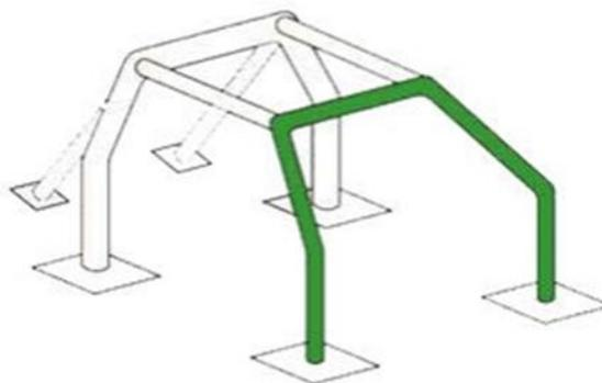
Configuration du « halo » : Un arceau de toit (halo) suit la ligne du toit composé d'une seule pièce de chaque côté de l'arceau principal le long du haut des portes et du pare-brise. Un HALO doit être connecté au plancher par une tubulure verticale suivant la ligne des piliers avant avec un maximum de 4 coudes, pour un total de 180 degrés  $\pm$  10 degrés et un maximum de 2 coudes autorisés sur la tubulure verticale.
