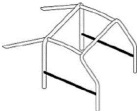
Les barres de la porte peuvent être parallèles (schéma 253-11), ou sous la forme d'un «X» (schéma 253-9).
