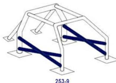
Au moins une des deux barres du «X» doit être en une seule pièce. Si les deux barres de portière ne se croisent pas en forme de «X», un minimum de deux tubes verticaux doit être joint aux deux barres latérales.
