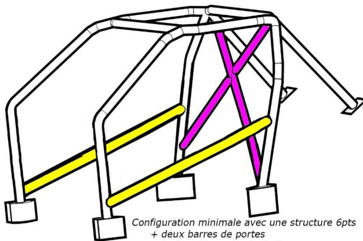
Configuration minimale avec une structure 6pts
