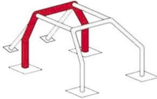
L'arceau principal doit incorporer une entretoise diagonale latérale pour empêcher la torsion latérale de l'arceau. La pose de barres d'armature supplémentaire au sein de la structure de la cage est autorisée et non limitée.
