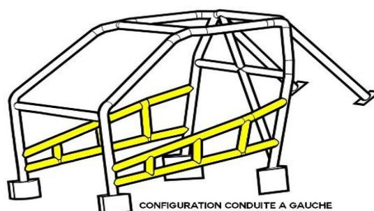
Dans cette configuration, les barres extérieures doivent également être jointes par un minimum de trois (2) tubes verticaux reliant les barres supérieures et inférieures. Le panneau de portière intérieure et l'intérieur de la portière peuvent être enlevés.
